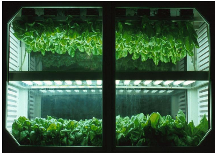
図4. 地上でのレタスの逆さ吊り下げ栽培 上下栽培棚の中央に蛍光灯光源を配置し，上下方向に光を照射。
